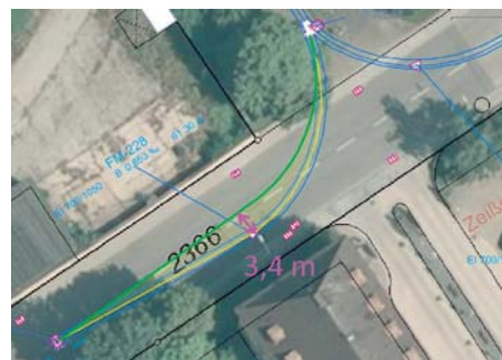
Leitung wird lagevermessen und dokumentiert
