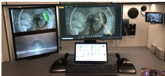
Regieraum vom JT-elektronik Fahrzeug mit der neuen kanDa-Steuerung und KI-Einfärbung auf dem Betrachtermonitor.
