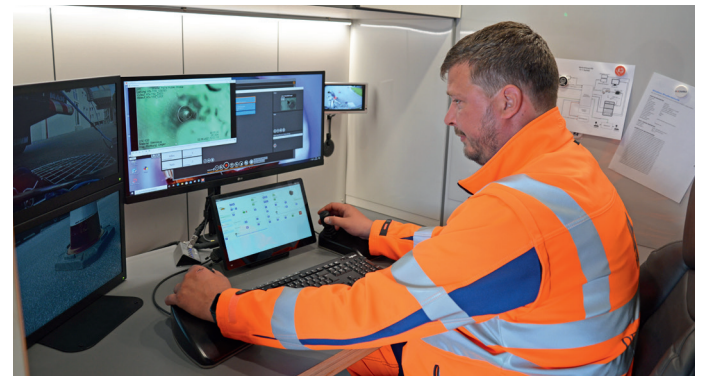
Moderner Regie- und Auswertepplatz für den Kanalinspekteur
