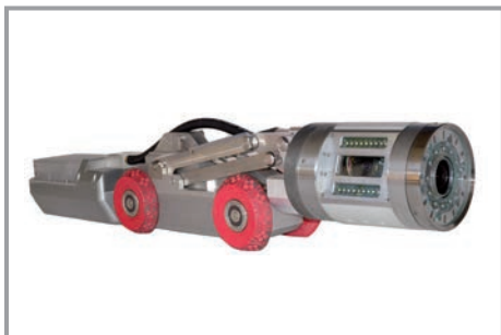
2003: JT-Kamerafahrer mit elektrischer Höhenverstellung und montierter SPHERIX-Kamera mit schlauchverbundenem Tender und dort integrierter PC-Einheit (Foto: JT-elektronik GmbH)
