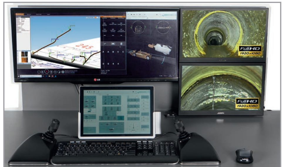
2020: Digitale Anlage mit frei konfigurierbarem Control Panel, Touch-Display und Multifunktionsjoysticks für eine optimale Bedienung der Gesamtanlage. (Foto: JT-elektronik GmbH)
