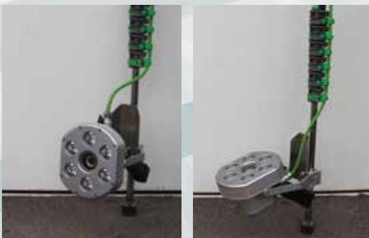
Der Kamerakopf lässt sich - 30° / + 90° nach unten / oben schwenken, damit Steigeisen und Schachtwandung begutachtet werden können.
