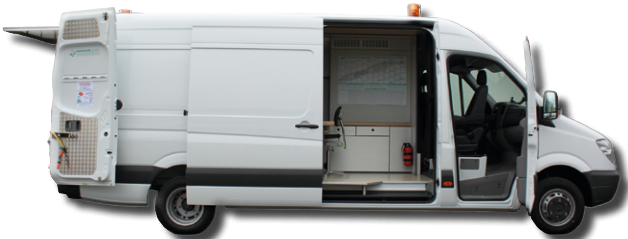
KFZ mit zulässigem Gesamtgewicht von 5,5 to mit Beifahrerdrehsitz und Schwenktüren 270°
