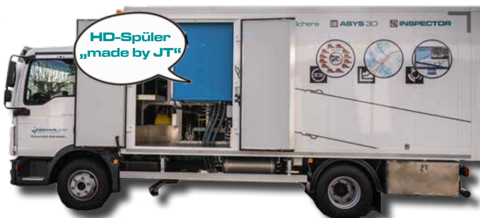
Großzügiger Zugang zur HD-Technik. Stauraum, elektr. Befüllhaspel, Sicherheitstechnik und Zubehör.
