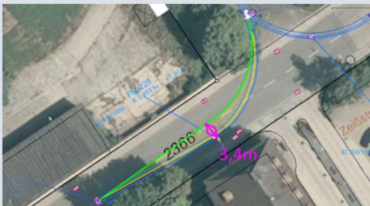
Bild 14: Planunterlagen der Haltung FM-228 (blau) und Ergebnis der Vermessung mit hakASYS (grün)
