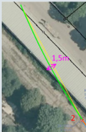
Bild 13: Bogenförmiger Haltungsverlauf zwischen Schacht 2 und 3
