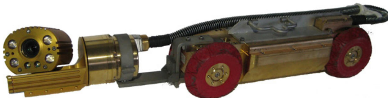
Bild 1: JT-Fahrwagen mit integrierter Sensorik zur Haltungsvermessung
