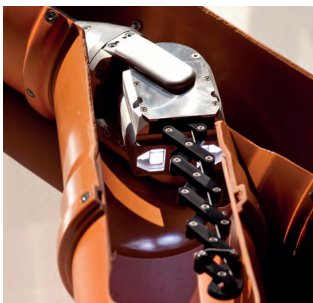
Das Kamerasystem Lindauer Schere während des Abbiegevorgangs
