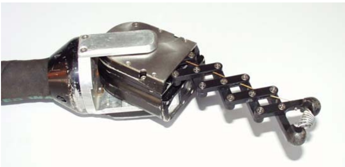
Funktion der Schere herausgefahren
