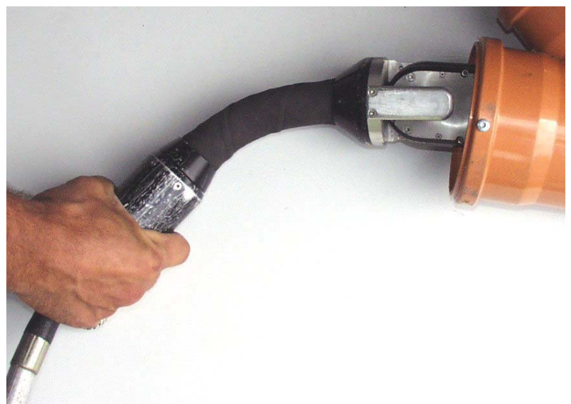
Darstellung der Biegsbarkeit der Lindauer Mini-Schere in horizontaler Richtung
