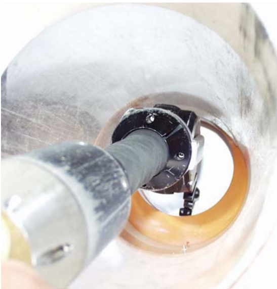
Einsatz der Lindauer Mini-Schere Überwindung eines Höhenhindernisses in 90° vertikal-Stellung
