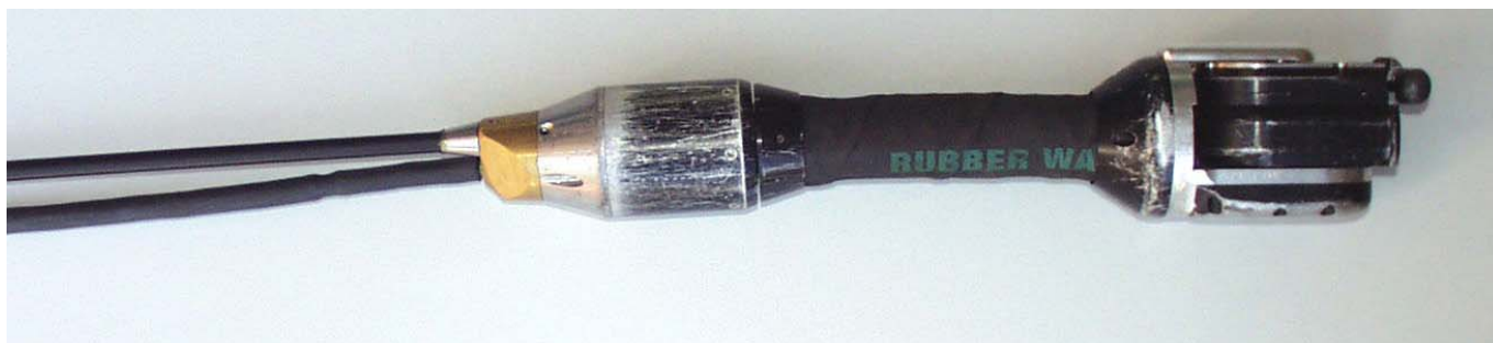
Lindauer Mini-Schere Vorschub über Schiebbestangen
