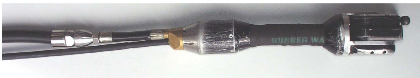
Lindauer Mini-Schere Vorschub über HD-Schlauch mit Düse
